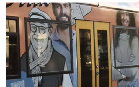
An TW661 werden die Fenster neben den Mitgeltüren komplett beklebt. Schlecht für Personen mit Kinderwagen, die erst im letzten Moment erkennen können, ob der Mehrzweckplatz bereits voll ist.
